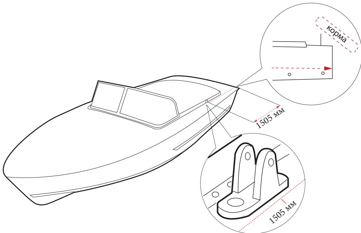
1. Установите кронштейн крепления дуг к корпусу лодки, на расстоянии 1505 мм (по центру кронштейна) от корпуса лодки со стороны кормы (см. рис). На нашем сайте, в разделе «инструкции» мы можете посмотреть фотографии размеров.
